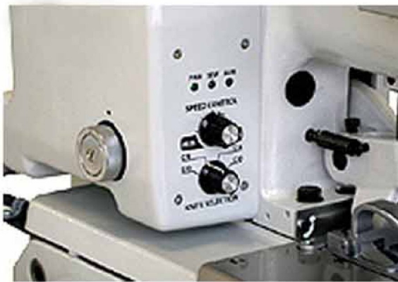
控制面板 检验错误 缝制速度 ( 1000~2000spm ) 球状选择把手 ( 先开孔后本缝/先本缝后开叉/只切不缝/只缝不切 )
